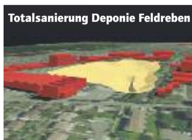
Eine Baugrube 380 m lang, 210 m breit (9 Fussballfelder!) und 23 m tief sowie knapp 1 Mio. m³ Aushub.
